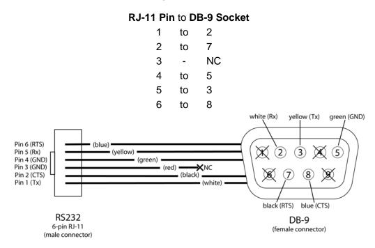
Figure 3-4. RS232 Comm Cable Wiring
